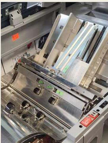
Les feuilles sont ensuite guidées vers la machine suivante où le bord intérieur de chaque page est fraisé afin d'entamer le papier, pour faciliter la prise de la colle avant d'être encollé en passant sur les rouleaux enduits de colle.
